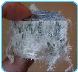
L'amianto o asbesto è un minerale naturale caratterizzato da una struttura microcristallina
